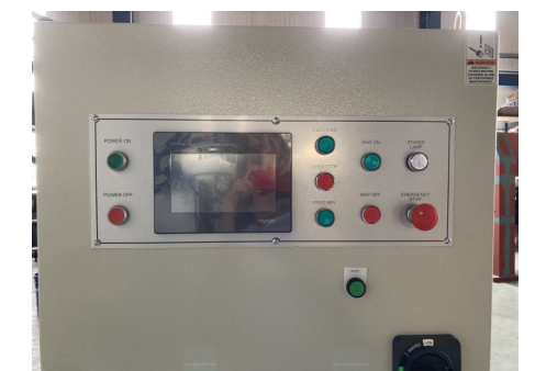
Pannello di controllo per avviamento e funzioni parametriche di gestione della macchina
