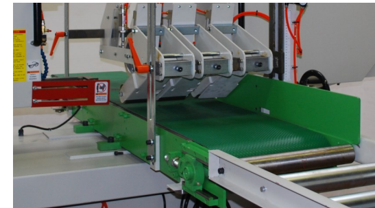
Tappeto di avanzamento a velocità variabile Belt with adjustable feeding speed
